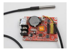
Type: DS18B20 Working voltage: 4.2-5.5V temperature range: -55--125  $^\circ \rm C$  temperature precision:  $\pm 1 \, ^\circ \rm C$
